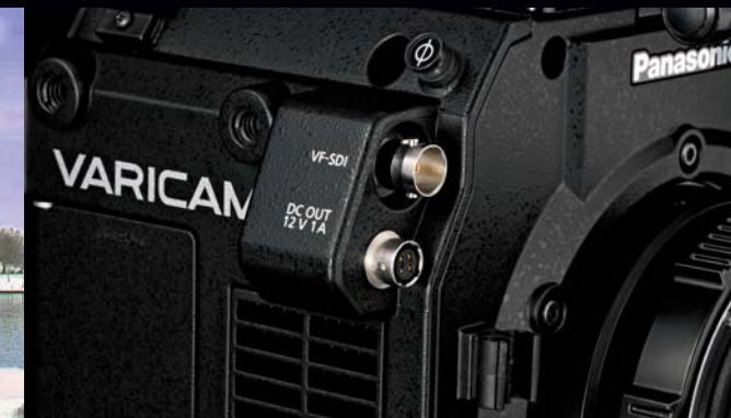
Разъемы электронного видеодискетеля с интерфейсом HD SDI и источником пост. тока
